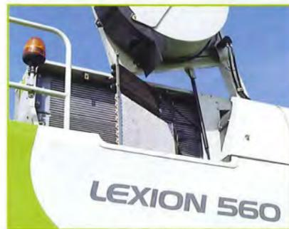
mögliche Last-Kraft-Verteilung sichergestellt wird. Das Kühlsystem der LEXION-Mähdrescher ist mit einem schwenkbaren Kühlerkorb mit Staubabsaugung und hydraulischem Antrieb ausgestattet, was eine hohe Standzeit und lange Wartungsintervalle bedeutet.
